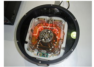
Кольцевой лазерный гироскоп киевского завода «Арсенал» на МАКС-2011
