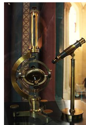
Гироскоп, изобретённый Фуко (построил Дюмолен-Фромент, 1852)
